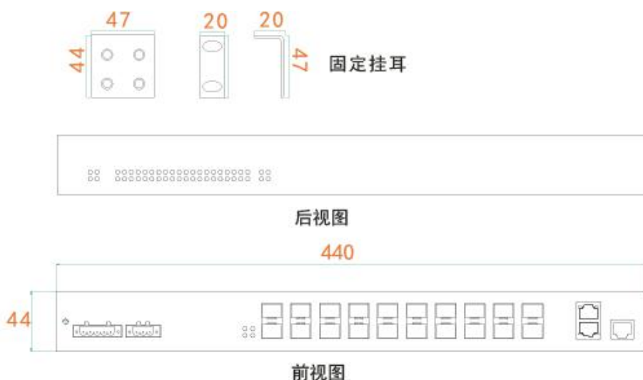
图 12. 装置机箱结构图
