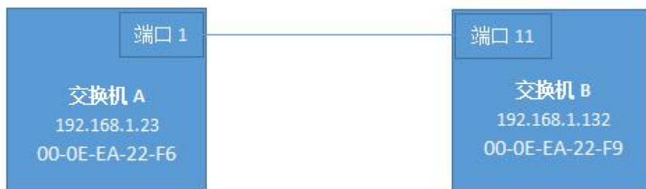
图 4-2-3 LLDP 拓扑测试示例连接
